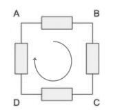
$V_{AB} + V_{BC} + V_{CD} + V_{DA} = 0$
